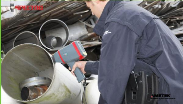
Der Einsatz moderner in Planartechnologie gefertigter Driftdetektoren auf Halbleiterbasis bildet die Grundlage für leistungsfähige Systeme. Der Übergang auf das Substratmaterial Germanium wird so eine hinsichtlich Genauigkeit, Portabilität und Universalität überlegene Generation an Geräten hervorbringen
